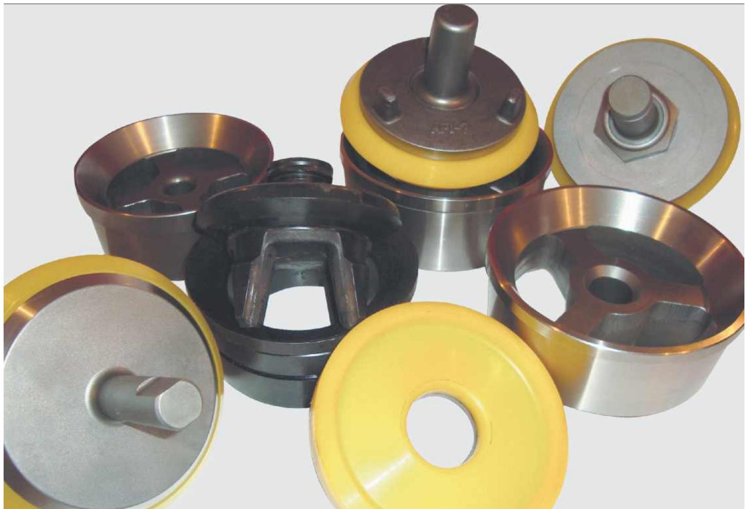
Son fabricados en aceros aleados de cementación (AISI 8620), forjados según norma, cementados y tratados térmicamente a 60/62 HRC, con el propósito de obtener una elevada resistencia al desgaste y a los efectos del lodo, posteriormente rectificados en las superficies cónicas y criogenizados para aumentar hasta un 30% más su vida útil.
