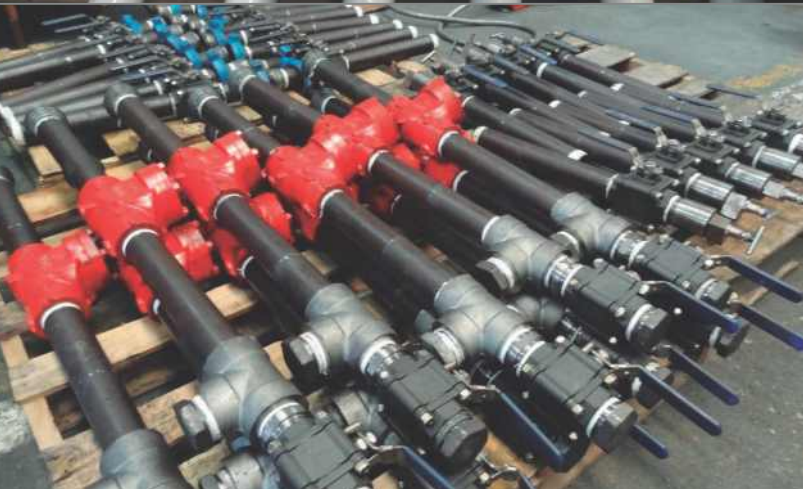
puentes de producción production manifolds / manifolds de produção
